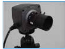
三次元動作解析装置 Vicon DV（動画）カメラ
