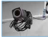
三次元動作解析装置 Vicon Bonitaカメラ
